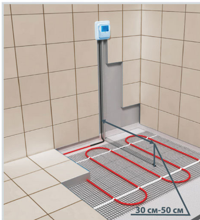
Схема укладки датчика температуры в гофрированной трубке
